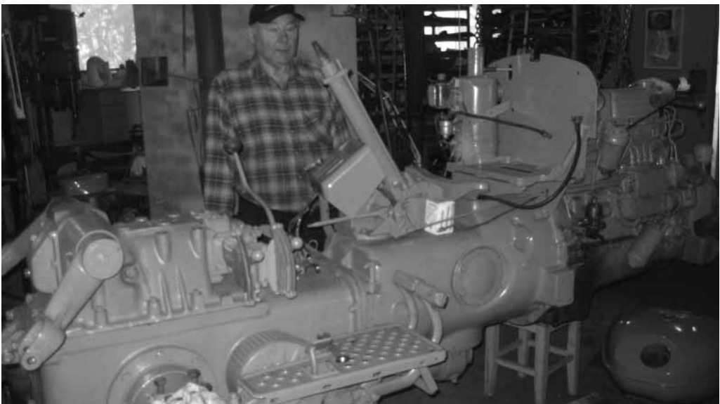
Denne motoren med drivverk ser ut som ny fra fabrikk. Thorleif har bygget den sammen av deler fra flere årganger av Fordson Major.
